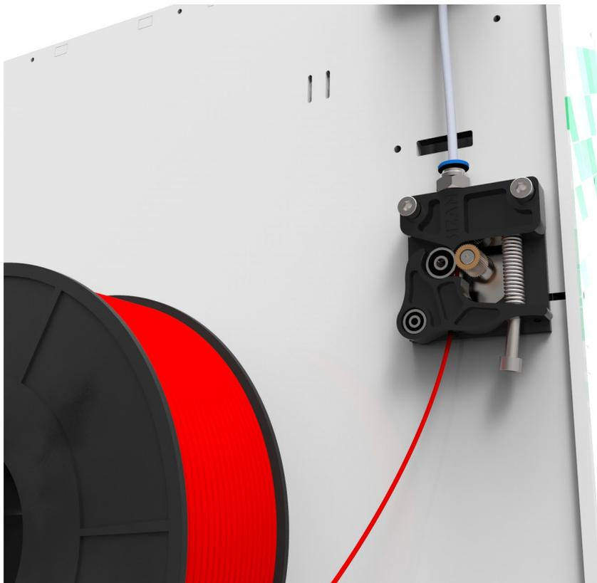
استفاده از اکسترودر با روش Bowden باعث جریان ملایم و یکنواخت مواد اولیه می شود. مهم تر از آن بر خلاف اکسترودرهای Direct که بر روی محورهای حرکتی سوار هستند و وزن سنگین موتور باعث ایجاد تنش و لرزه در حرکت می شوند در روش Bowden وزن موتور روی دیواره پشتی دستگاه است و فشار و وزنی روی محورهای حرکتی نخواهد بود.
